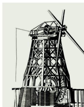
2.11 Jan Adriaansz. Leeghwater, Werktekening van een Beemstermolen (ca. 1610).
